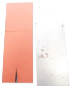
Aspecto de la muestra después del ensayo de inflamabilidad según UNE-EN ISO 11925-2:2011 (aplicado en borde)
