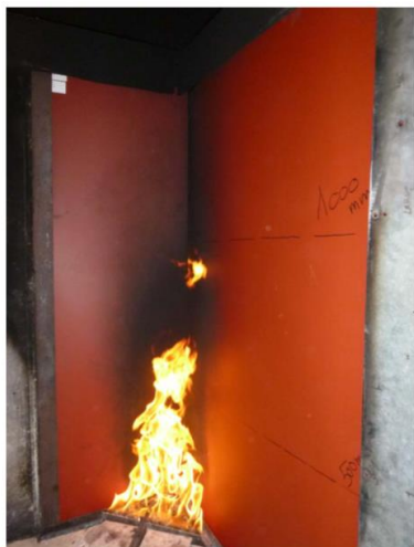
Aspecto de la muestra durante el ensayo de SBI según UNE-EN 13823:2012
